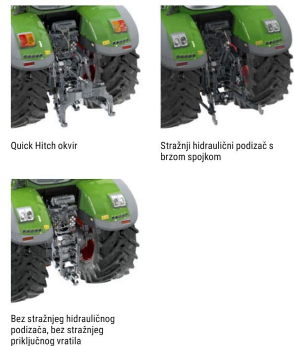
Quick Hitch okvir      Stražnji hidraulični podizač s brzom spojkom
