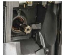
■ Šipke PTO-a posebno su jednostavne za spajanje zahvaljujući ukošenom i istaknutom profilu.
