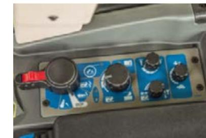
U upravljačkoj ploči EHR-a, stražnja dizalica može se pregledno podesiti. S automatskom funkcijom, rad se može postaviti na višenamjensku upravljačku tipku.
