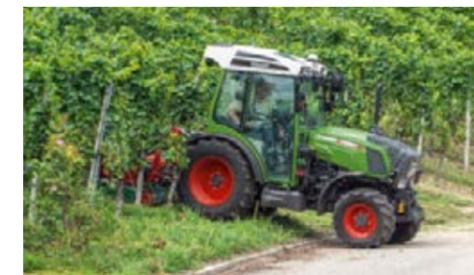
PTO radi neovisno o brzini vožnje. Za vožnju z. B. kosidba velikih zaliha polako i s malo inventara brže, kontinuirano, bez prekidanja ili prekida snage.
