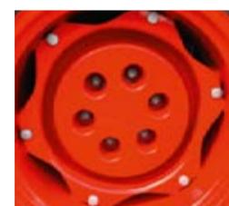
□ S dodatnim utezima kotača povećavate vuču stražnje osovine.
