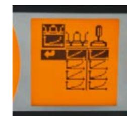
■ Možete ugodno postaviti osjetljivost hidrauličkih upravljačkih jedinica na zaslonu.
