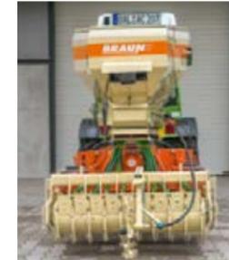
Donja poluga može se podesiti desno i lijevo preko dva hidraulička cilindra i usmjeriti stražnju jedinicu točno u liniju. Slobodno plutanje je moguće u plutajućem položaju.
