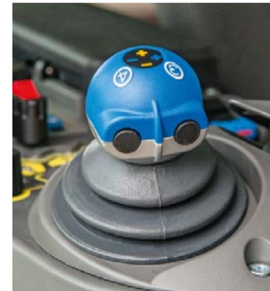
■ Treći i četvrti upravljački krugovi prikladno reagiraju na rukovanje električnom križnom polugom kao tipkom ili prekidačem.
