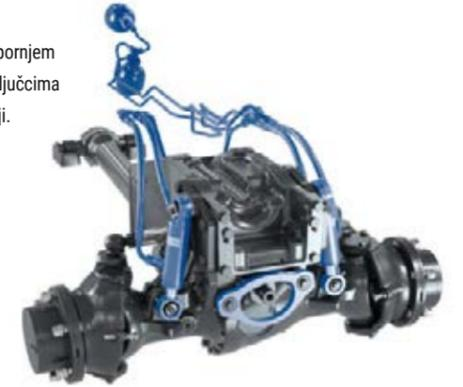
Očuvanje tla je kombinacija mnogih mjera: Samoregirajuće polužje sa širokom i niskom prednjom vučnom točkom, pogonom na sva četiri kotača i automatskom blokadom diferencijala, regulacijom razine i nosačem prednje osovine. Optimalno prljanje u svim uvjetima.
