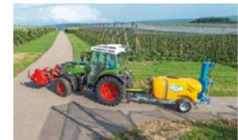
Učinkovita kombinacija radnih procesa. S prednjim pogonskim zglobom 540E / 750 vozite mulčer u radnoj brzini, dok prskalica straga i traktor rade s smanjenim brojem okretaja motora.
