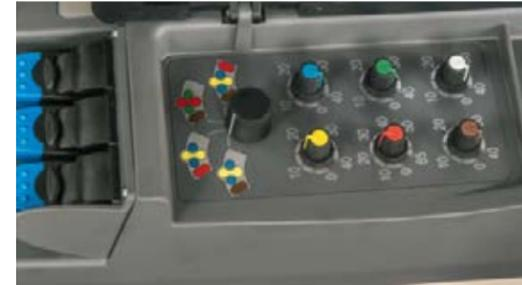
Udobna višenamjenska upravljačka poluga kontrolira sve pomoću kontrolnih gumba: Stražnje poluže, regulacijski ventili, tempomat, regulator broja okretaja. Pomoću desne poprečne poluge možete vrlo osjetljivo upravljati 1. i 2. ventilom. Tipke na poprečnoj poluzi kontroliraju 2 električne funkcije.
