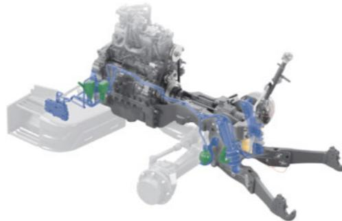
Prednji podizni uređaj je potpuno integriran i kompaktno se uklapa na vozilo. To drži zapregu vrlo agilnom. Donje poluge imaju posebno dobro podvozje i mogu se sklopiti u parkirni položaj. Baloni štite cilindar za podizanje od udaraca o kamen. Standardno prigušivanje vibracija sprječava ljuštanje i jamči sigurnost i udobnost vožnje.
