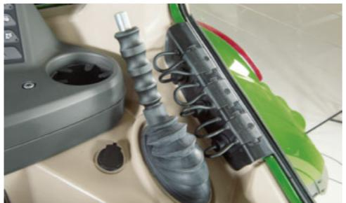
Što se tiče kablova koji se moraju voditi od stražnjeg dijela traktora do kabine, Fendt nudi pametno rješenje. Neovisno o presjeku, svaki kabel se može uredno položiti u provodni kanal. Stražnje staklo se pritom može zatvoriti te prašina, voda i buka ostaju vani.
