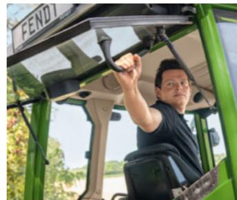
Posebna značajka traktora Fendt 200 Vario okomita je ručka na stražnjem staklu kojom se staklo jednostavno sjedeći može otvoriti i zatvoriti.
