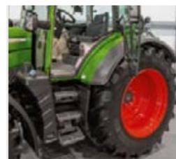
■ Uspon i spuštanje zaštićeni su od bočnog onečišćenja. Tu su i široke stepenice i dobro postavljeni rukohvat za siguran i jednostavan uspon i spuštanje. Ručku na vratima izuzetno je lako dosegnuti s tla.
