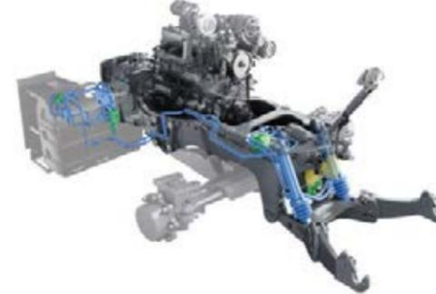
Prednja dizalica je potpuno integrirana i kompaktno se uklapa na vozilo. To drži zapregu vrlo agilnom. Donje poluge imaju posebno dobro podvozje i mogu se sklopiti u parkirni položaj. Baloni štite cilindar za podizanje od udaraca o kamen. Standardno prigušivanje vibracija sprječava ljučenje i jamči sigurnost vožnje i udobnost vožnje čak i kod velikih opterećenja.
