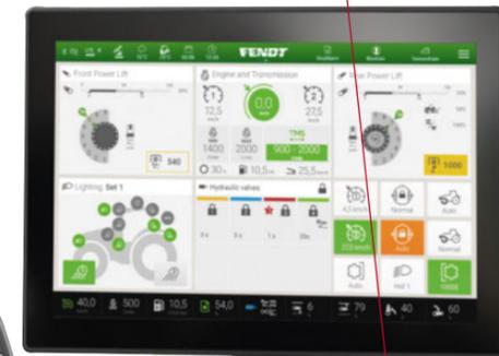
Upravlja svim prikazima Fendt 300 Vario središnjim okretnim gumbom. To također uključuje četiri gumba za brzi pristup za povratak, lansirnu ploču, pregled, upravitelja pojedinačnih operacija (IOM) i prebacivanje između terminala i nadzorne ploče.
