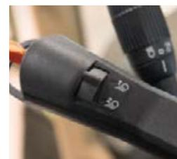
■ Dva načina osvijetljenja za pohranu: Prekidač na ručici za vožnju unazad omogućava brzo prebacivanje između dva spremljena načina osvijetljenja, npr. način ceste i polja.
