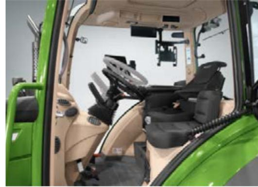
Savršeno ergonomsko podešavanje: Volan i kokpit mogu se brzo i lako podesiti pomoću nožne papučice. Za optimalno sjedenje moguće je podesiti visinu i pravi kut nagiba upravljača. Prednost: Optimalan pogled i izbjegavanje refleksija u pilotskoj kabini. Da biste se lako izvukli, jednostavno zakrenite kolo upravljača i kokpit pritiskom na nožnu papučicu.
