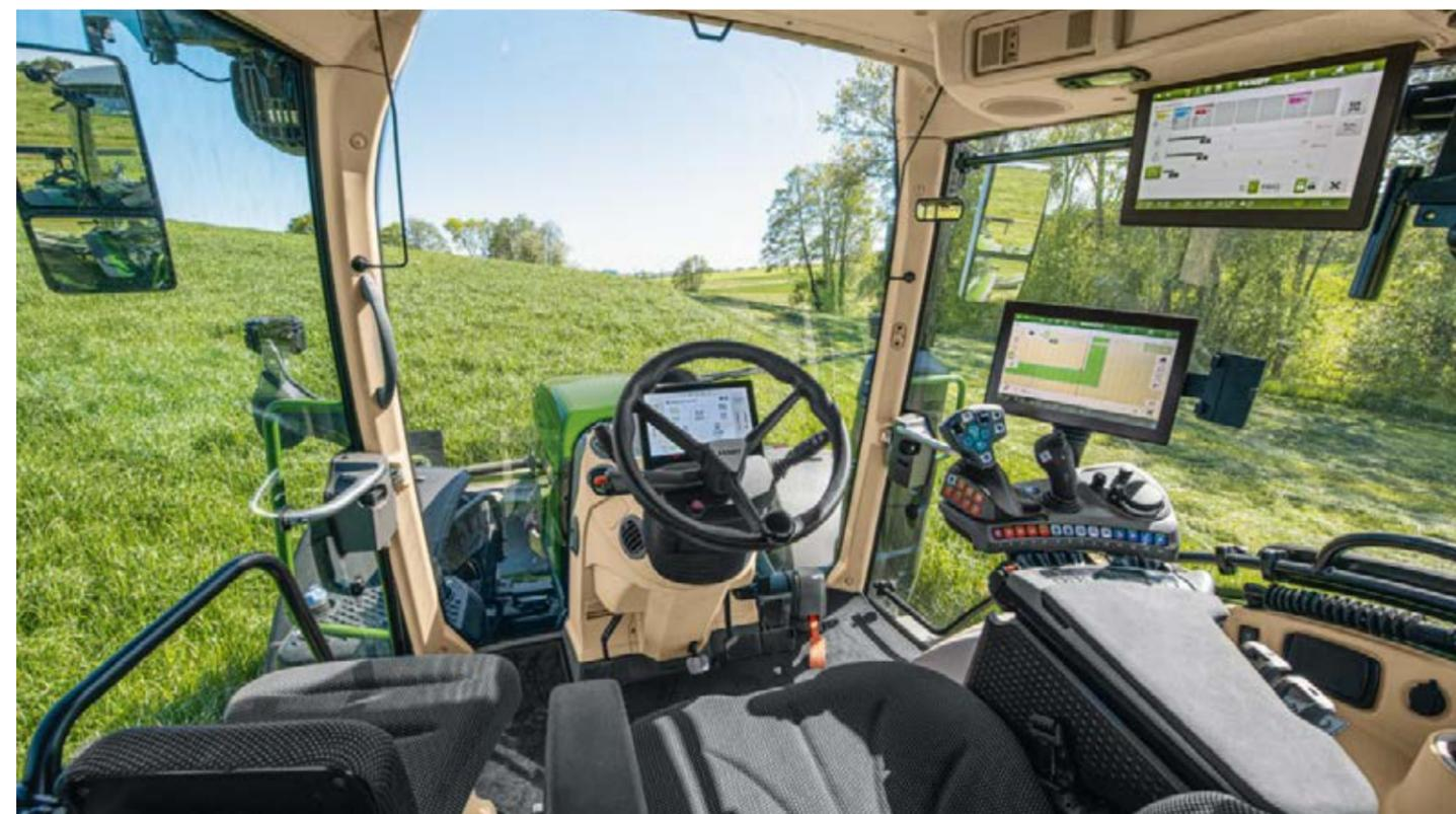
Što se tiče kablova koji se moraju voditi od stražnjeg dijela traktora do kabine, Fendt nudi pametno rješenje. Neovisno o presjeku, svaki kabel se može uredno položiti u provodni kanal. Stražnje staklo se pritom može zatvoriti te prašina, voda i buka ostaju vani.
