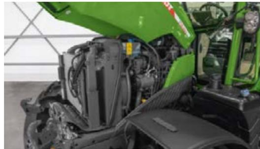
Prostor motora je lako dostupan za pregled i održavanje, čak i s priključcima za prednji utovarivač. Poklopac s dvije odvojene bočne ploče udoban je za otvaranje.
