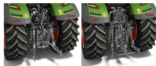
Zadnji pogonski lift s kukom za brzo hvatanje i bočnom potporom (EU)
