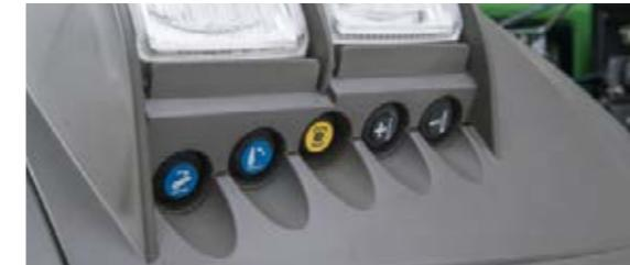
■ Vanjskim upravljanjem ventila pokrećete stražnju hidrauličku dizalicu, ventil i priključno vratilo izravno na stražnjem blatobranu. Također, kod vanjskog pokretanja stražnjeg priključnog vratila moguće je automatski aktivirati prethodno postavljen broj okretaja motora. Tako si štedite vrijeme za nepotrebne aktivnosti, poput, primjerice, punjenja spremnika za gnojivo.
