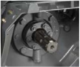
Priklučno vratilo se ističe izvanrednom učinkovitošću, jer se prijenos sile do izvoda vratila vrši se pogonskom osovinom izravno iz Vario mjenjača. Istovremeno se standardne brzine okretaja postižu već s brojem okretaja motora ispod 2.000 o/min, što se pozitivno odražava na potrošnju goriva.
