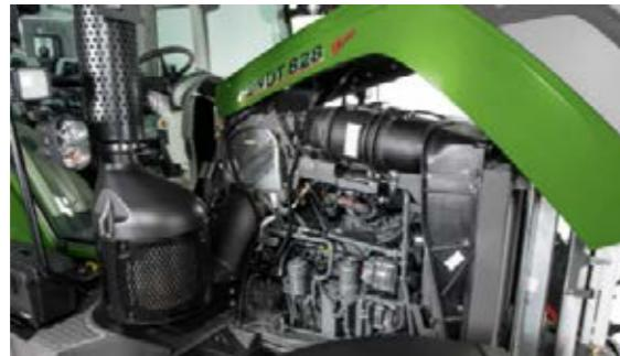
Prostor motora je posebno dobro dostupan zahvaljujući zakretnom poklopcu motora i lako uklonjivim bočnim dijelovima.
