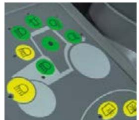
■ Svjetla je, zahvaljujući preglednom prikazu, moguće podešiti vrlo jednostavno. Sa sustavom jedne tipke svi se radni reflektori mogu aktivirati samo jednim pritiskom na folijsku tipkovnicu.
