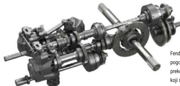
Fendtov Vario mjenjač je hidrostaticko-mehanički glede učinkovitosti raznovrsni vozni pogon. S većom brzinom, povećava se i udio snage koja se mehaničkim putem prenosi preko planetarnog sklopa. Za ovaj izvanredni stupanj učinkovitosti zaslužni su hidrostati koji se mogu zakrenuti za 45 stupnjeva, ali i radni tlak od maksimalno 550 bari.
