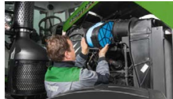
Zračni filter se može ukloniti brzo i jednostavno.
