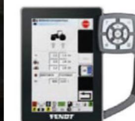
Tlak zraka u gumama moguće je regulirati pritiskom na gumb, preko Varioterminala. Sustav asistencije upozorava vozača na preniski ili previsoki tlak zraka u gumama.
