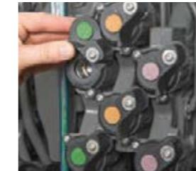
□ Zahvaljujući DUDK spojki (obostrano spajanje pod tlakom), priključivanje i odspajanje priključnih uređaja iznimno je jednostavno. Poklopci ventila koji se sami zatvaraju štite od onečišćenja te omogućuju priključenje hidrauličkog voda samo jednom rukom.
