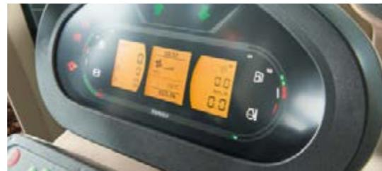
■ Unutrašnje osvjetljenje u traktoru 800 Vario savršeno je usmjereni na bitna područja. I danju i noću, bitni radni elementi ugodno su osvijetljeni. Prema uvjetima vidljivosti, intenzitet osvjetljenja automatski se regulira pomoću svjetlosnog senzora.
