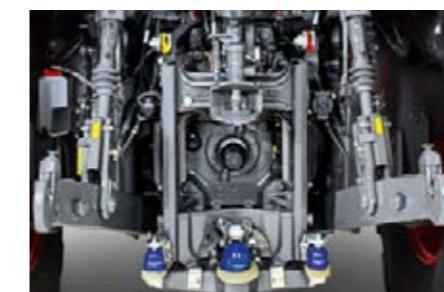
Donje kopče stražnje hidrauličke dizalice mogu se preklopiti kad je traktor parkiran, tako da time nastaje dodatni slobodni prostor prema rudu priključnog vozila.
