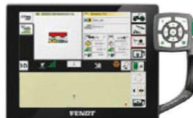
VarioDoc omogućava bežični prijenos podataka s Varioterminala u sustav upravljanja oranicom. Osim toga, VarioDoc Pro konstantno bilježi podatke o položaju i stroju te je prijenos podataka moguć i preko mobilne radioveze.
