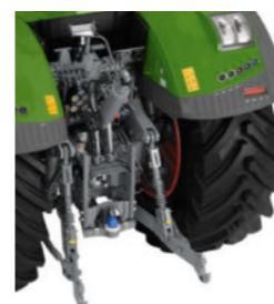
Stražnji hidraulični podizač s brzom zahvatnom kukom i bočnom potporom (EU)
