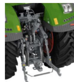
Stražnji hidraulični podizač s brzom zahvatnom kukom i blokovima Rub Block (AU)
